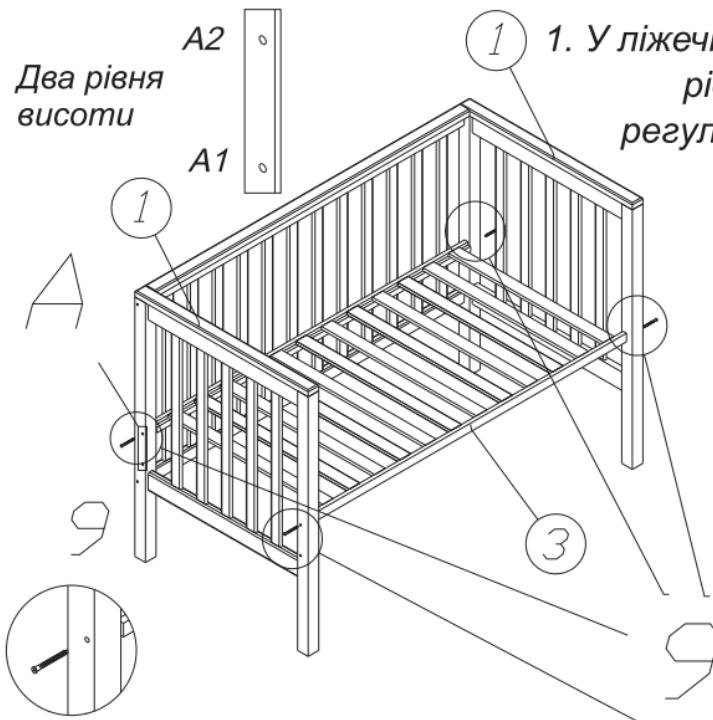
1. У ліжечку «ALEX» від ТМ «Гойдалка» рівень висоти спального місця регулюється і має два положення. Залежно від обраного Вами рівня, ламельний низ (3) закріплюється у відповідні отвори спинок ліжка (1) за допомогою конфірматів 7x70 (9) і ключика під гвинт-конфірмат (16).
