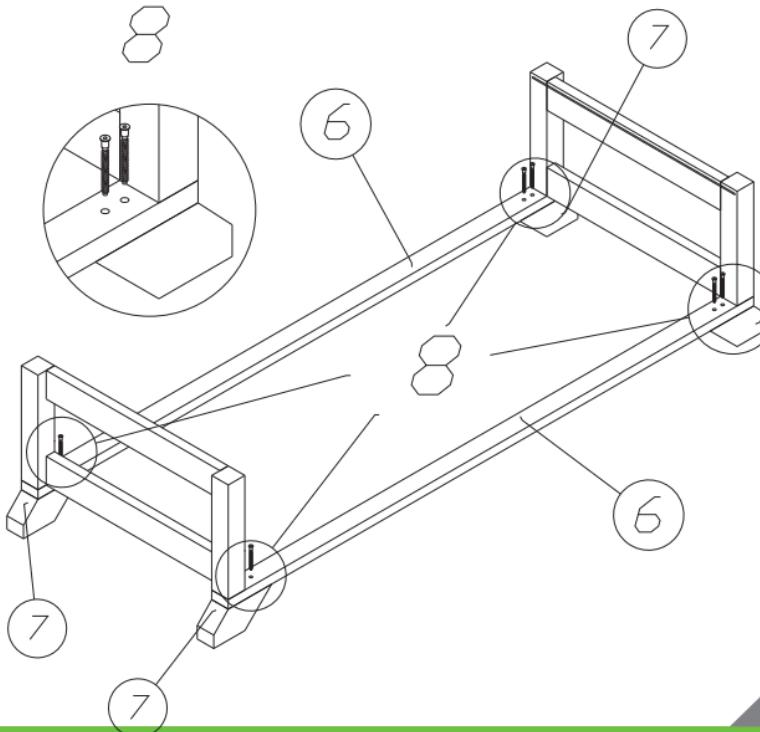
1. Прикручуємо ніжки (7) під ліжко до з'єднувальних планок каркасів 40x20 (6) за допомогою конфірматів 6,4x50 (8) і ключика під гвинт-конфірмат (16).
